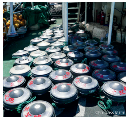
Des transpondeurs de DCP. Chaque transpondeur sera fixé à un DCP et transmettra des informations sur les poissons présents sous le DCP, ainsi que leur position.
