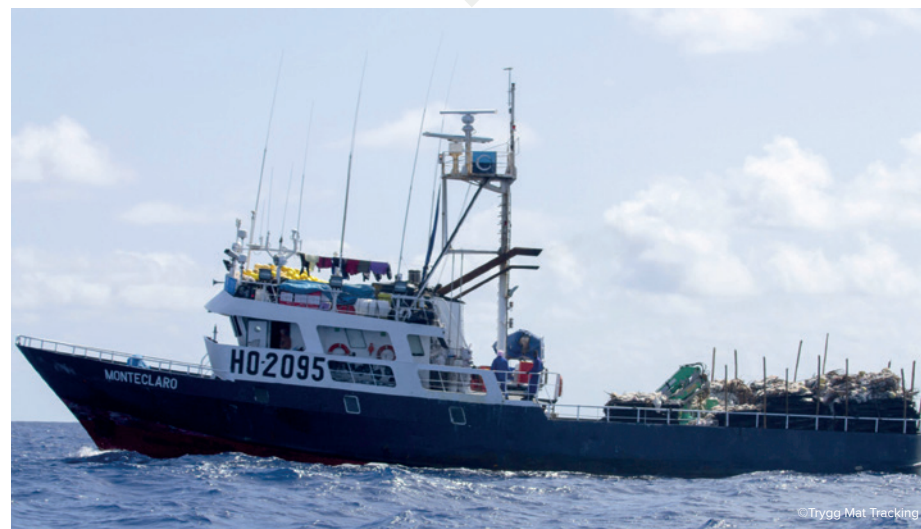
Un navire de soutien thonier dédié au déploiement et à la récupération des DCP
