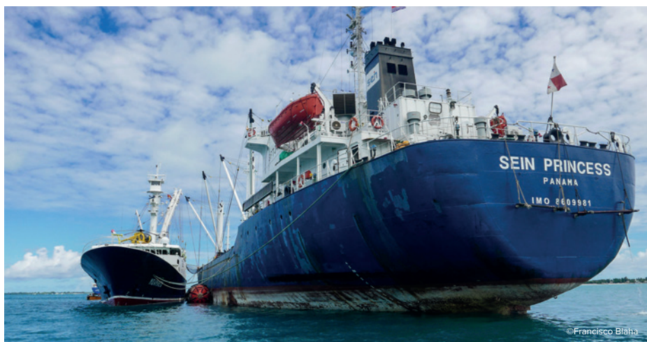
Transbordement au mouillage en zone portuaire. Notez la défense « Yokohama » de grande taille déployée entre le transporteur et le navire receveur.
