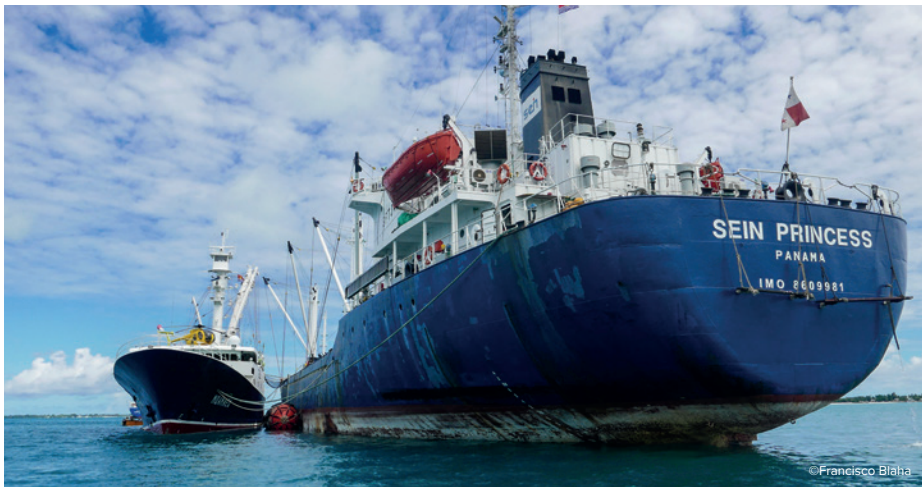
Transbordo en fondeadero en zona portuaria. Fíjese en el gran guardabarros ‘Yokohama’ desplegado entre el carguero y el buque que está descargando.
