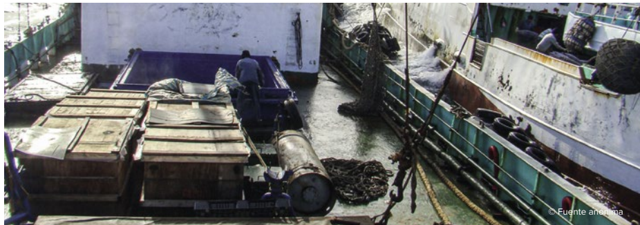
(Arriba) Buque palangrero transbordando a un buque de carga en el mar. Puede observarse el uso de defensas Yokohama.
